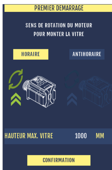
- Figure 10 Premier démarrage du boîtier de contrôle de motorisation -
