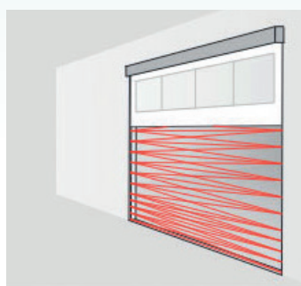
Figure 4: Portes souples rapides avec effacement des faisceaux (SB et DB types)
